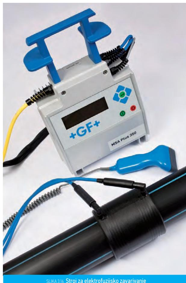
SLIKA 3.16. Stroj za elektro-fuzijsko zavarivanje
