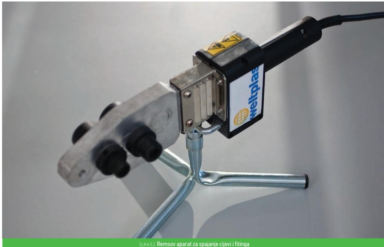
SLIKA 5.2. Remsov aparat za spajanje cijevi i fittinga
