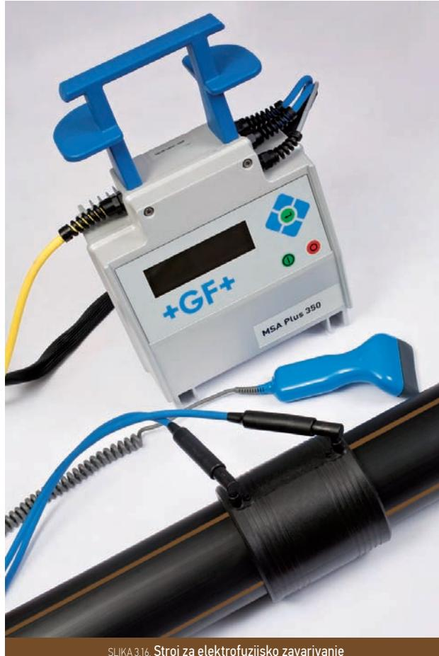
SLIKA 3.16 Stroj za elektrofuzijsko zavarivanje
